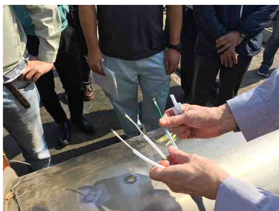
写-4-3 モニタリング用塩分センサ
