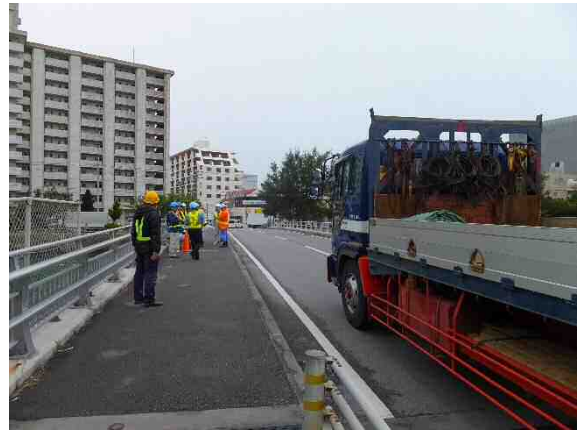
写-2-4 大型車両走行載荷状況
